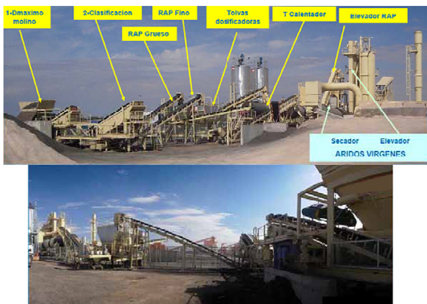
Figura 7: Tratamiento del RAP en línea. (Fuente: Sacyr)
