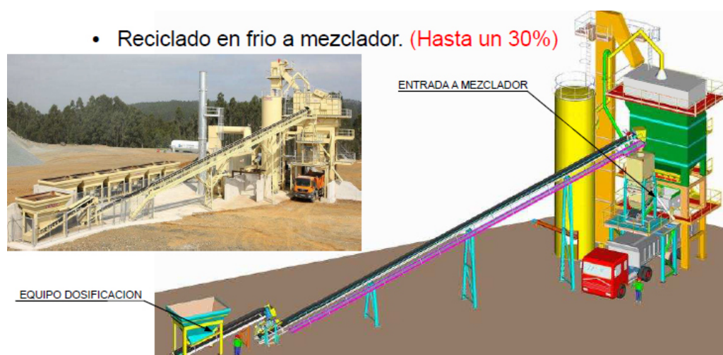
Figura 13: Central de mezcla discontinua con sistema de dosificación del RAP, directo al mezclador. (Fuente: Intrame)
