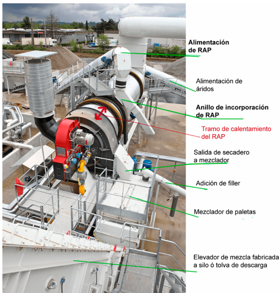
Figura 17: Central de mezcla continua de contraflujo, con anillo de incorporación de RAP y mezclador independiente (Fuente: Intrame)
