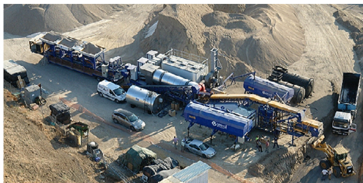
Figura 10: Central de mezcla continua diseñada específicamente para la fabricación de MBTE. (Fuente: Fabremasa)
