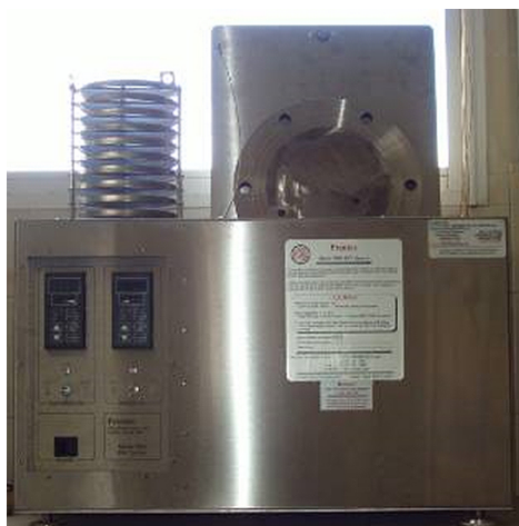
Figura 37: Equipo empleado para el envejecimiento del residuo de emulsiones bituminosas
