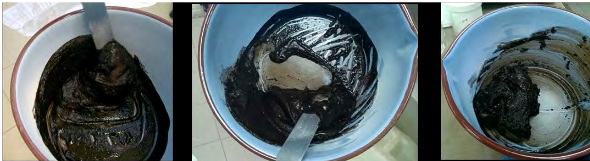
Figura 2. Evolución típica del ensayo de índice de rotura. Instantes iniciales, mitad de ensayo y finalización.
