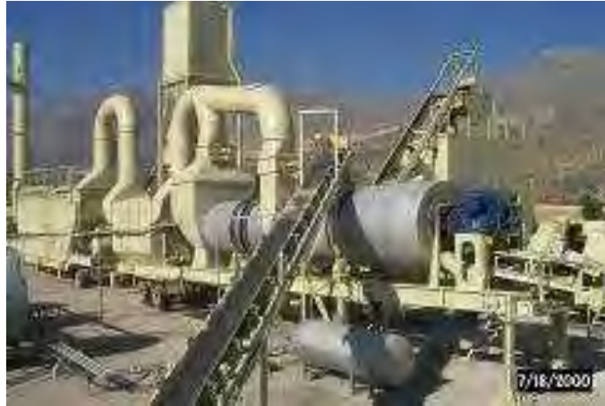
Figura 4. Planta continua de flujo paralelo con la incorporación del RAP por el centro del tambor.
