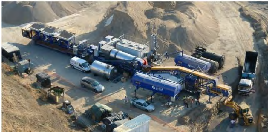
Figura 1. Planta asfáltica en continuo diseñada específicamente para la fabricación de MBTE
