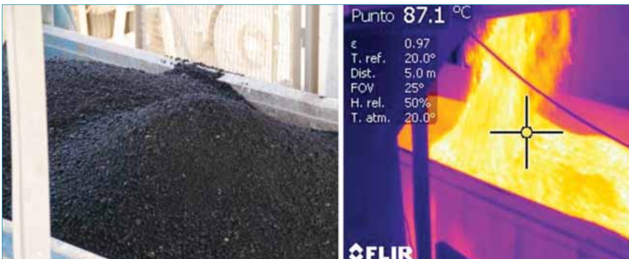
Figura 9: Mezcla reciclada templada a tasa total. Ausencia total de humos. Tª salida mezclador: 94.2°C.
