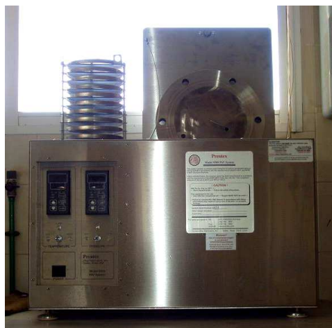
Fotografía 2. Cámara de envejecimiento a presión PAV (Pressure Ageing Vessel)
