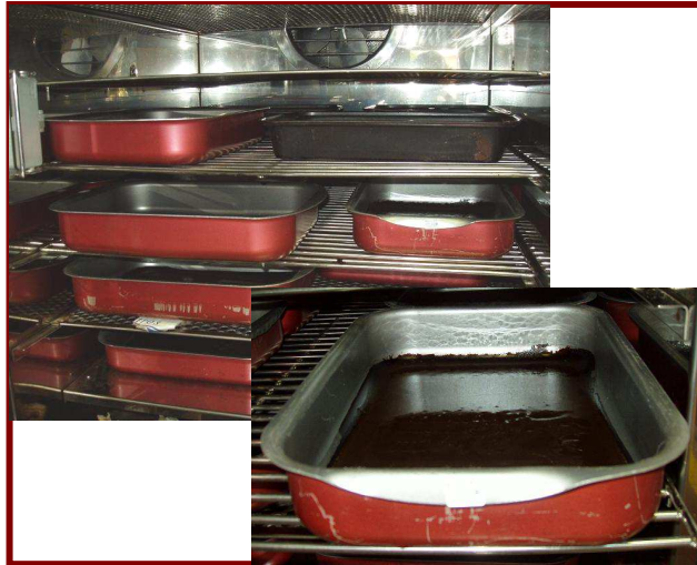
Fotografía 1. Disposición de las bandejas de ensayo para la obtención del ligante residual de las emulsiones en la cámara climática.
