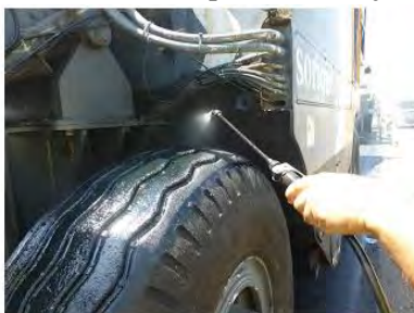
Figura 12. Detalle de la aplicación del tratamiento antiadherente. Fuente blog Motores y Carreteras
