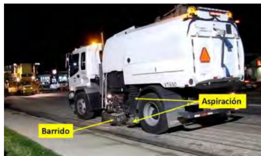
Figura 9. Detalle del barrido de una superficie fresada. Fuente blog Motores y Carreteras
