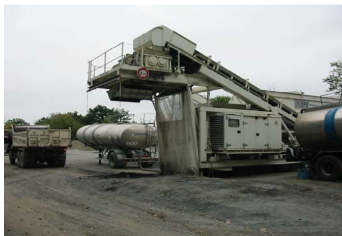
Planta de fabricación de Mezclas bituminosas abiertas en frío.
